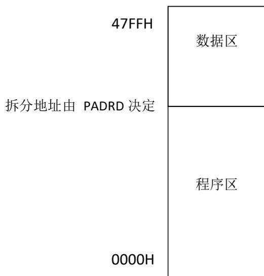
图 7-3-1 18K Flash 存储器结构
