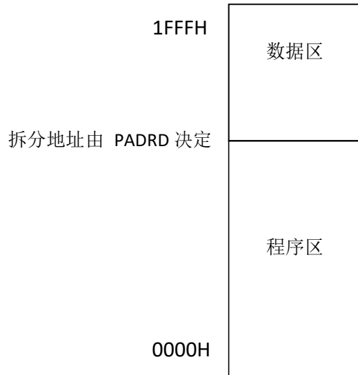
图 7-3-1 8K Flash 存储器结构
